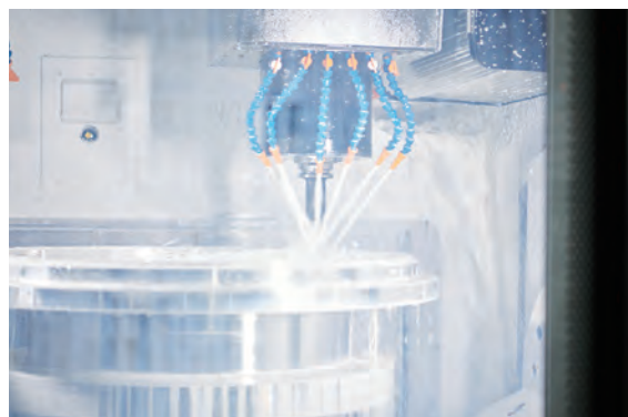
工具の全周から切削液をかけ、切削加工している様子
